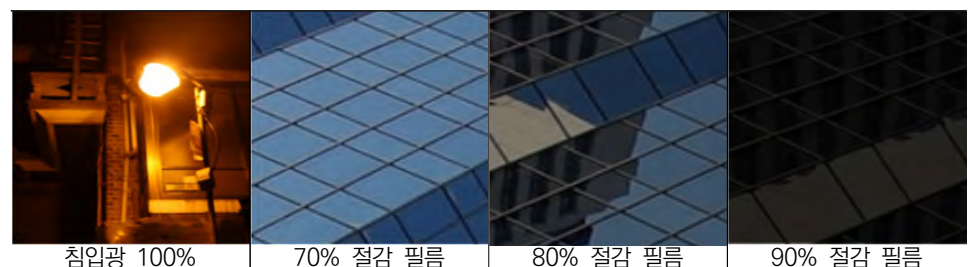
[그림 4-7] 차광필름 설치
