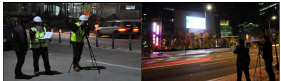
[그림 5-58] 시공 후 심의결과 평가 예시(빛환경 측정 사례) (출처: 2014.05 / 2014.10 촬영)
