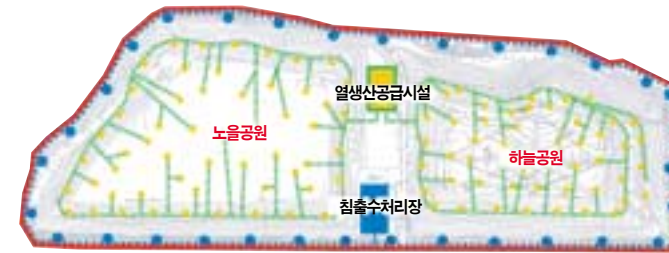
침출수 처리 차수벽 총길이 6,017m, 집수정 200m 간격 31개소 가스포집공 120m 간격 106개소
