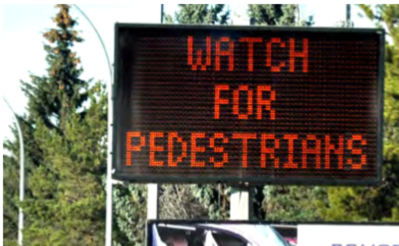
[그림 2] 보행자 보호와 과속차량 단속 등을 수행하고, 전방 도로상태 정보 등을 알려주는 이동식 전광판
